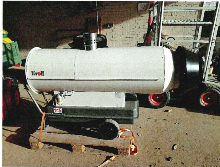
Abb. 4: eingesetztes Heizgerät mit 91kW Leistung
